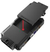
LOWER THE EXPANSION PACK INTO THE REMOTE STARTER
